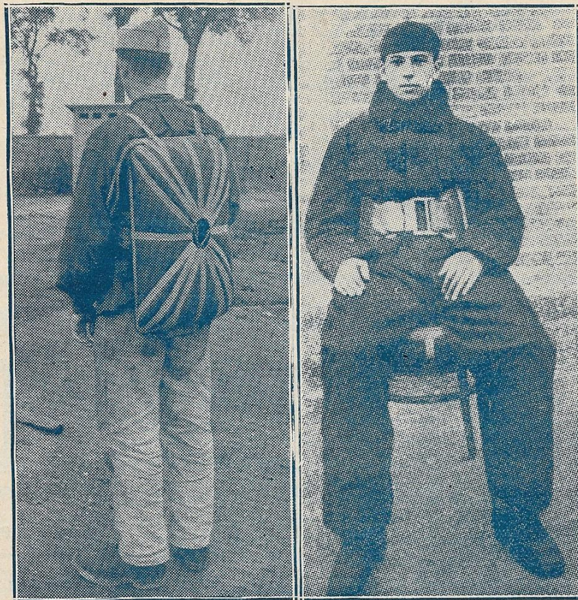
Equipement sac dorsal avec ceinture-corsset à bouclage et débouclage rapide (vue de dos).
